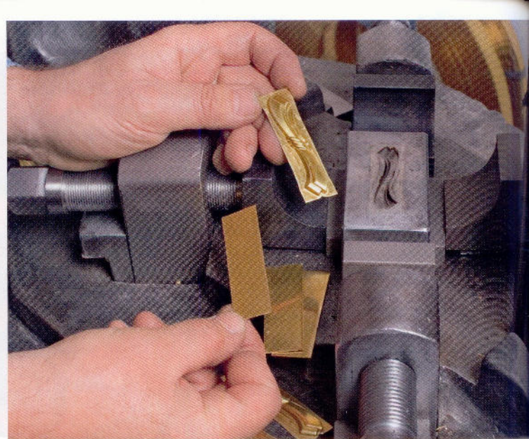
... die Prägung diffiziler Schmuckstücke mit dem Fallhammer erfolgt...
