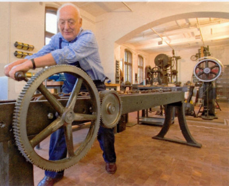
... oder aus Drähten und Blechstreifen mittels einer Ziehbank Armreifen oder Creolen entstehen
